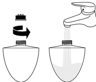
drinkwater uit. Voor hernieuwd gebruik vult u de tank met vers drinkwater. Als het uitgeschakelde instrument voor een langere periode buiten gebruik zal zijn, verwijder dan de watertank van het instrument en leeg deze.
