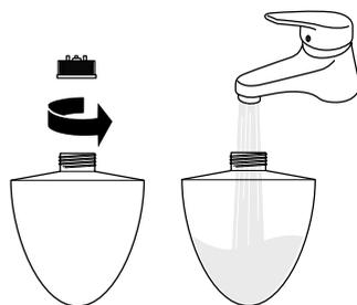
fresca. Prima di un nuovo utilizzo riempire il serbatoio di acqua potabile fresca. Se si spegne l'apparecchio e non lo si intende utilizzare per un lungo periodo, togliere il serbatoio dell'acqua e svuotarlo.
