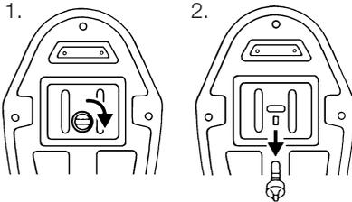
Die Sicherung oberhalb der Anzeige abziehen, umdrehen und wieder einsetzen.
