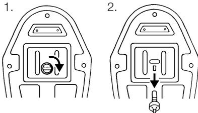
Rimuovere il fermo al di sopra del display, ruotarlo e reinserirlo.
