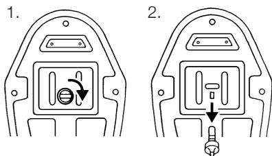
Oter le dispositif de blocage au-dessus du cadran, le faire pivoter, puis le
